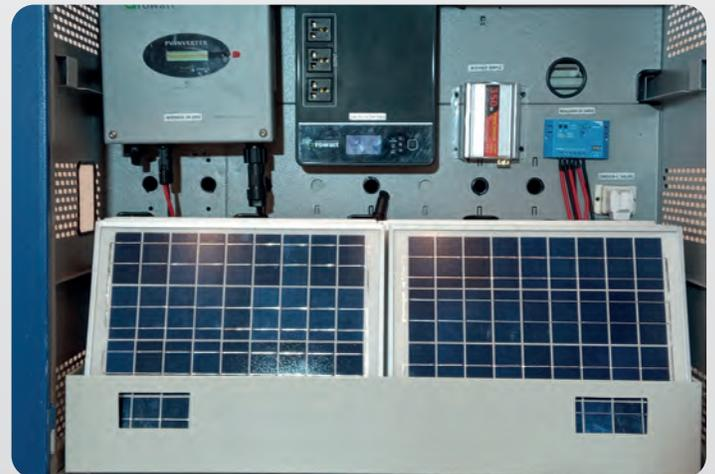
**d.** En la imagen superior se aprecia el arreglo de paneles ya ubicados dentro del carro. Detrás de los paneles se encuentran alojados los cables de conexión, y en el bolsillo de puerta lateral derecha se encuentran las herramientas, el instrumental, las morsetas y la tornillería requerida para su ensamble. Una vez que todas las partes constituyentes y accesorios han sido guardados en el gabinete, la estación está lista para su traslado, tal cual se puede ver en la Imagen 4.
