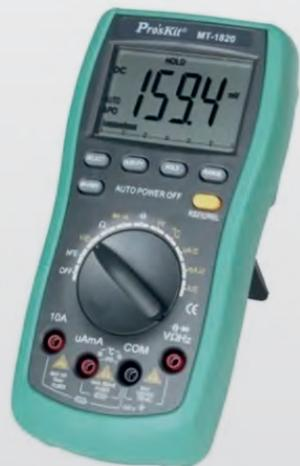
← **Multímetro** con sus respectivas puntas de medición. Con este instrumento se pueden realizar exactas mediciones, entre otras, de tensión y corriente (para realizar esta última es necesario abrir el circuito bajo medición e intercalar el multímetro en función amperímetro en serie con el circuito a mensurar).
