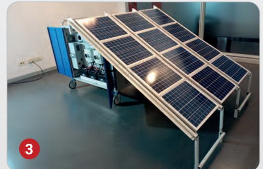
La estación EPEF Profesional es completamente modular, incluye un conjunto de 12 paneles fotovoltaicos mono cristalinos, tres inversores, un regulador de carga, un banco de 4 baterías, protecciones eléctricas, cables de conexiones, instrumental de medición para ensayos de laboratorio y un medidor bidireccional.
