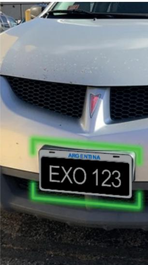
La detección de patentes por videocámaras permite desde llevar un control de los vehículos en un predio, hasta combinarlo con sistemas que agilicen el paso por barreras si un automóvil cuenta con lugar reservado con antelación desde una web o aplicación móvil.
